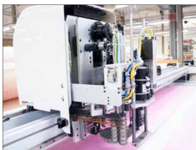
Cabeçote reforçado para tecidos pesados
