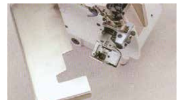
Preparada para instalação de dispositivos para elástico
