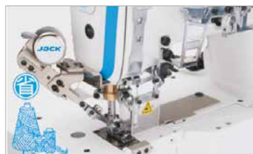
Corte de linha automático na linha UT
