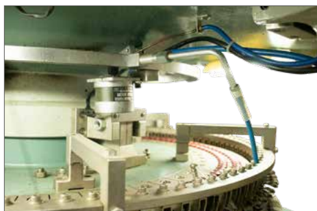
Sistema de limpeza
